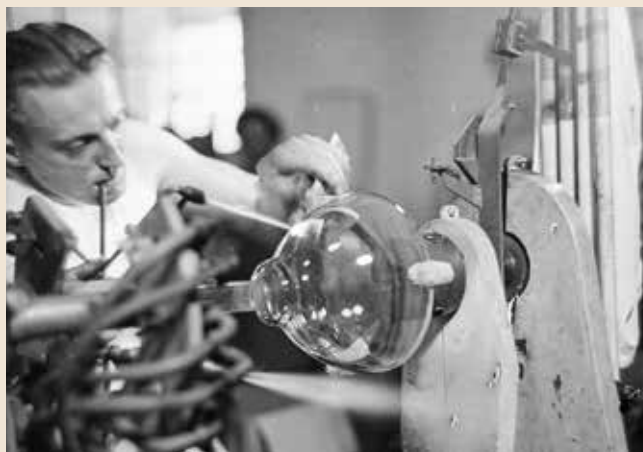
Glasbläser beim Bearbeiten eines Bildröhrenkolbens im WF, 1952 © industriesalon.de, CC BY-SA
