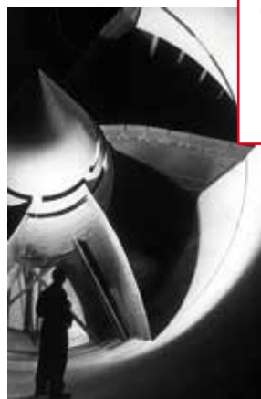
Zur Erzeugung des Luftstromes im großen Windkanal diente ein Gebläse mit 8,5 Metern Durchmesser. © SDTB, Historisches Archiv, Foto: Hans Schaller
